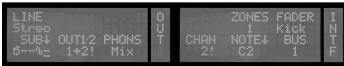
Den Output-Buchsen OUT1•2 werden die Busse 1 und 2 zugeordnet
